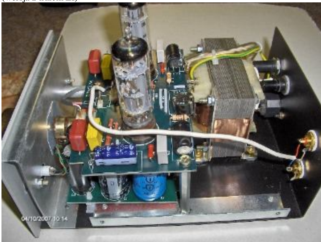
Montaż płytek w obudowie (wersja z trafem EI)
