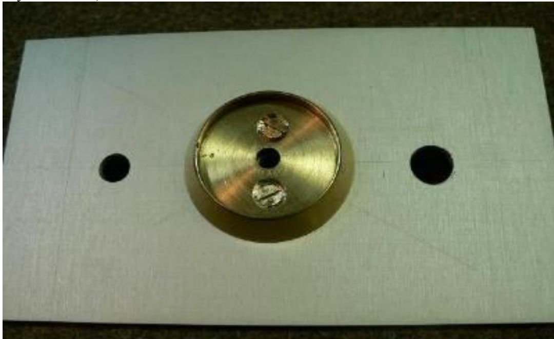
Płyta czołowa, obróbka
